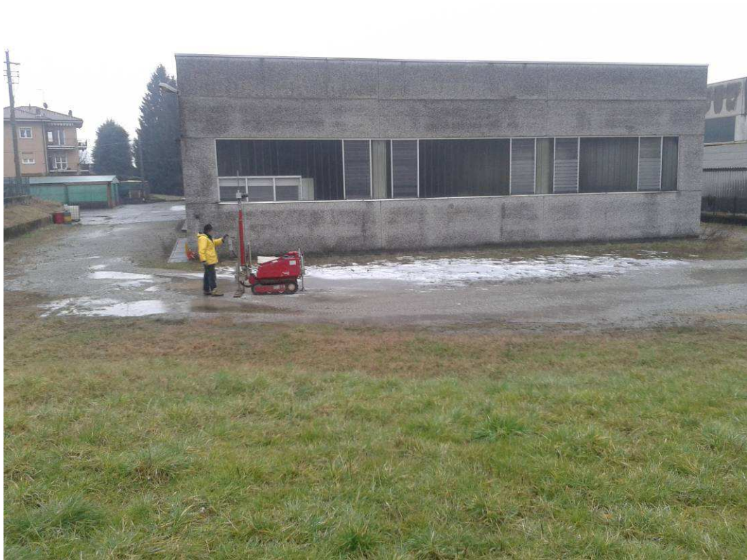
Foto 3: Esecuzione prova scpt
